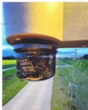
▲ Die unscheinbaren Module sind robust und erfassen bewegte Objekte witterungsunabhängig und präzise im Nahbereich. Ist kein Objekt in Sicht, bleibt die Laterne auf einem flexibel einstellbaren, minimalen Leuchtniveau.
